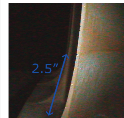
Fisura localizada en el alabe 27, la imagen muestra la distancia entre la fisura y la raíz del alabe.
